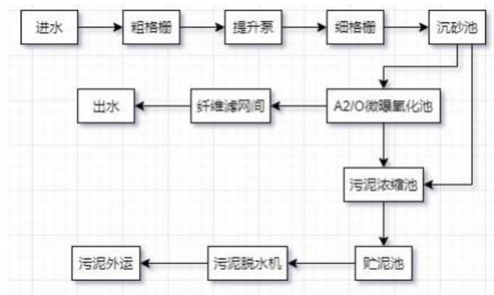
表 4-2 云浮市高新区污水处理厂处理工艺流程图
